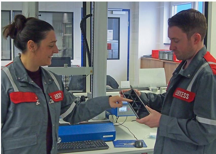
Für die Verrippung des Demonstrators wurde kein zusätzliches Anspritzmaterial verwendet. Er besteht komplett aus fließgepresstem Tepex flowcore.
