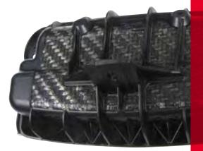
Dass Hightech-Kunststoffe im Automobilbau nicht nur eine Alternative zu Metallen, sondern auch zu konventionell im Spritzguss gefertigten Kunststoffkonstruktionen darstellen, belegt das von uns im Rahmen eines gemeinsamen Vorentwicklungsprojekts mit mehreren Partnern entwickelte Gehäuse für ein Beifahrer-Airbagmodul. Der Einsatz von Kunststoff-Verbundmaterialien verringert das Gewicht des Gehäuses gegenüber der aktuell in Serie gefertigten Ausführung aus Polyamid 6 um mehr als 30 Prozent.
