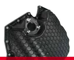
Auch unter der Motorhaube ist Leichtbau "angesagt". So wiegt eine neue Pkw-Motorölwanne aus Polyamid 66 für Benzin-Turbomotoren, die unter anderem in den Audi-Modellreihen A3, A4 und A6 sowie dem VW Passat zum Einsatz kommen, rund ein Kilogramm weniger als ein entsprechendes Stahlbauteil. Im Vergleich zu einer Ausführung in Aluminium ergibt sich eine Gewichtseinsparung von rund 50 Prozent. Da die Einsparung im Bereich der Vorderachse erzielt wird, verbessert sich zudem die Fahrdynamik.
