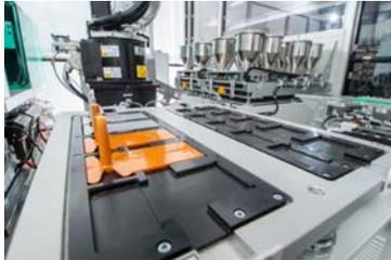
Als weltweit einziger Hersteller ist LANXESS in der Lage, die Hitzestabilität von Eisenoxidpigmenten in kundenspezifischen Rezepturen automatisiert zu testen. Foto: LANXESS AG
