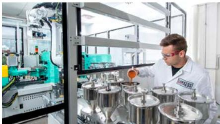
In seinem anwendungstechnischen Labor in Krefeld-Uerdingen verfügt der Spezialchemie-Konzern LANXESS über das nötige Equipment, um den Einfluss von Pigmenten für die Kunden aus der Polymerindustrie umfangreich zu testen und sie hinsichtlich einer Kolorierung mit Eisenoxidpigmenten zu beraten. Foto: LANXESS AG
