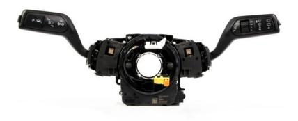
Substitution von Polyamid 66 durch das Polyamid 6 Durethan BKV30H3.0 in einem Lenkstockschaltergehäuse für verschiedene Fahrzeugmodelle von Ford. Das Bauteil wird im Schaumspritzgießverfahren hergestellt. Die Materialumstellung erfolgte im laufenden Serienwerkzeug, unterstützt vom LANXESS Engineering Service HiAnt. Fotos: Kostal
