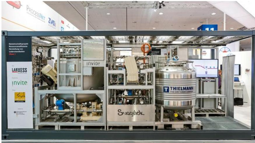
Die modulare Anlage für die „Ressourceneffiziente Herstellung von Lederchemikalien“ ist dafür konzipiert, in Gerbereien aus Falzspänen und pflanzlicher Biomasse direkt an Ort und Stelle Nachgerbstoffe der Marke „X-Biomer“ zur Fertigung von Leder herzustellen.
