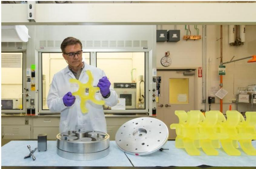
LANXESS entwickelt eine Vielzahl von Präpolymeren für die unterschiedlichsten Polyurethan-Anwendungen, etwa für so genannte Star Wheels zur Materialtrennung und zum Materialtransport. Durch den Einsatz künstlicher Intelligenz soll die Entwicklung maßgeschneiderter Rezepturen für Präpolymere beschleunigt werden. Die Tests finden im Forschungs- und Entwicklungslabor in Naugatuck, USA statt. Foto: LANXESS AG
