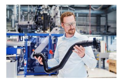
LANXESS hat im Technikum am Standort Dormagen eine hochmoderne Blasformanlage in Betrieb genommen. Zum Equipment zählt auch ein Werkzeug, auf dem u. a. Reinluft- und Ladeluftleitungen hergestellt werden können. Foto: LANXESS AG
