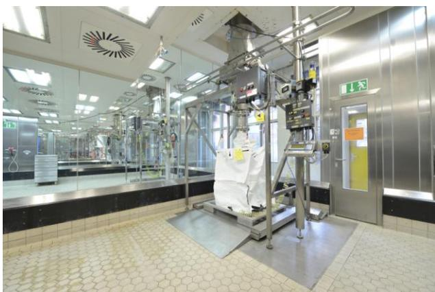
Feststoffabfüllungen von Zwischenprodukten und Wirkstoffen in Big-Bags bei der Saltigo GmbH in Leverkusen unter Reinraumbedingungen. Foto: Saltigo GmbH
