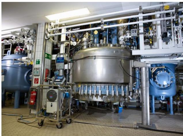
Reinigung einer Nutsche in der Leverkusener Plant 3 der Saltigo GmbH in Leverkusen. Dank der 2,5 Quadratmeter großen Filterfläche können damit pro Arbeitsgang ca. 800 Kilogramm Produkt filtriert werden. Foto: Saltigo GmbH
