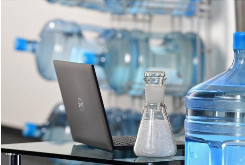
Die Matrix der neuen Halbzeuge besteht zur Hälfte aus Rezyklaten, die aus der Verwertung von Mehrweg-Wasserflaschen aus Polycarbonat stammen. LANXESS zielt mit den Produkten vor allem auf Anwendungen wie Laptopdeckel oder Gehäuse von Smartphones, Tablets, E-Books oder Handys. Foto: LANXESS AG
