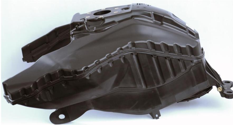
Die Tanks der Modelle F 900 R und F 900 XR von BMW Motorrad bestehen aus Durethan BC550Z 900116 DUSXBL. Mit dem unverstärkten und schlagzäh modifizierten Polyamid 6 sind die strengen Anforderungen der US-Umweltbehörde EPA hinsichtlich Permeation problemlos erfüllbar. Außerdem können die komplexen Geometrien wirtschaftlich spritzgegossen werden.
