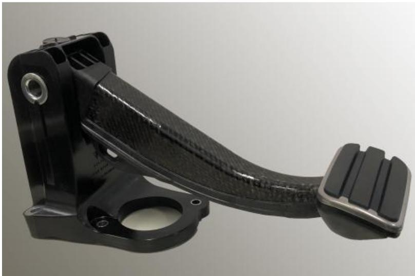
Vollkunststoff-Bremspedal für einen batterieelektrischen Sportwagen mit einem Einleger aus dem endlosfaserverstärkten, thermoplastischen Verbundwerkstoff Tepex dynalite von LANXESS.
