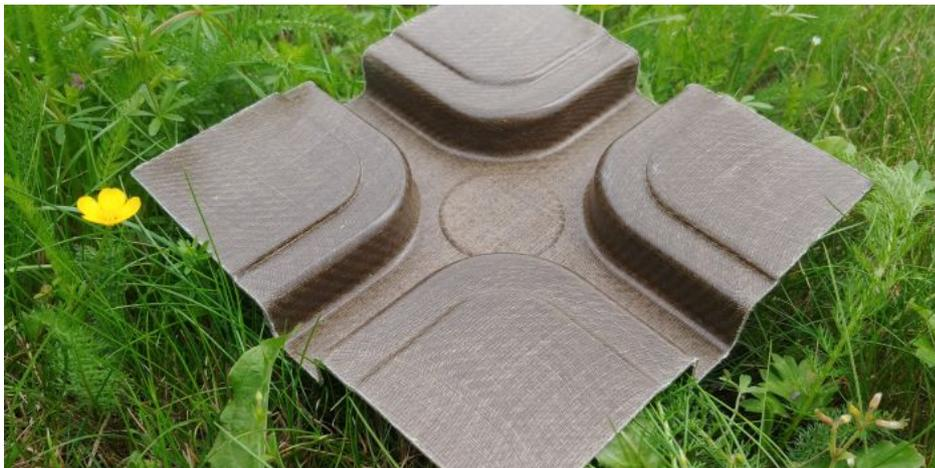
Demonstratorbauteil mit Polymilchsäure-Matrix und Gewebeverstärkung auf Basis von Flachsfasern. Die Bauteiloberfläche hat eine bräunliche Bio-Carbon-Anmutung, die von den Flachsfasern herrührt.
