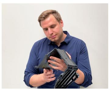
Der Halter ist so ausgelegt, dass der Kraftfluss von den Krafteinleitungspunkten größtenteils über die Endlosglasfasern des Verbundmaterials geführt wird. Dadurch werden die hohe Steifigkeit und Festigkeit des Einlegers aus Tepex optimal genutzt.
