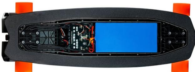
Das wannenförmige Deck nimmt bis auf die Motoren, die auf der Rückseite des Skateboards montiert sind, sämtliche elektrischen und elektronischen Funktionen inklusive Batterie auf.
