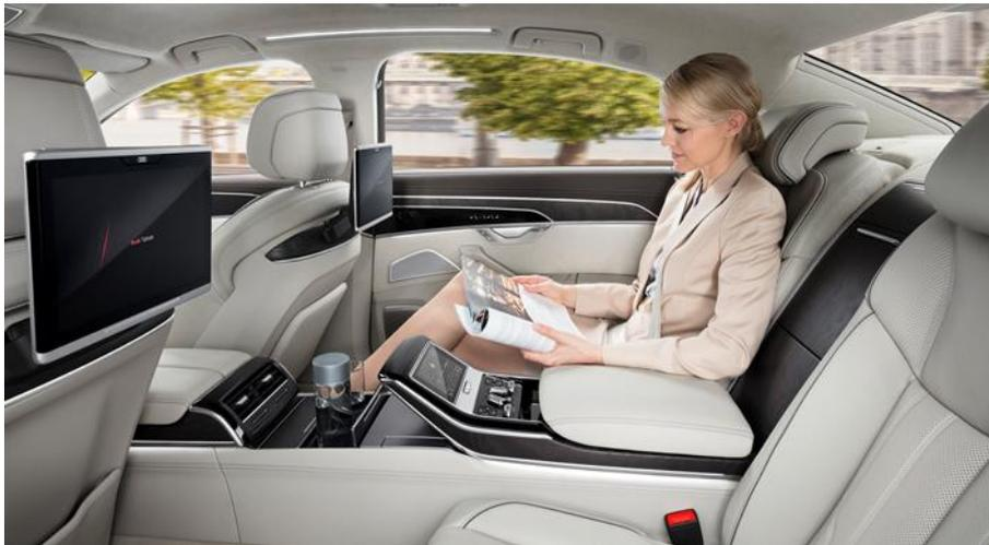
Der Audi A8 wird auch mit zwei elektrisch einstellbaren Einzelrücksitzen angeboten, deren Sitzschalen von Faurecia Automotive Seating entwickelt wurden und im Hybrid Molding-Verfahren mit Tepex dynalite 102-RG600(2)/47% gefertigt werden.
