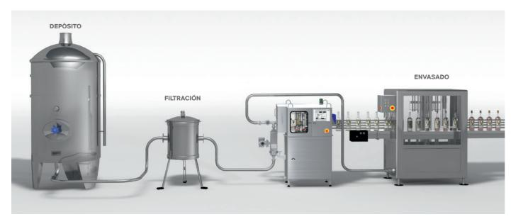
La unidad de dosificación Velcorin® se instala en líneas de llenado nuevas o ya existentes, y se puede utilizar para el tratamiento de tanque a tanque o en sistemas de llenado de contenedores. Sólo se requieren modificaciones menores de la línea de llenado para este propósito.
